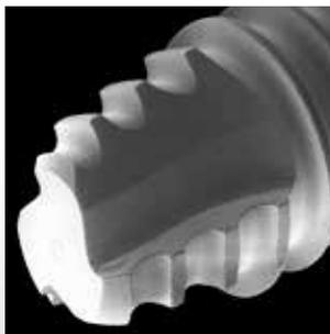
プラマインプラントの先端部には、高いセルフタップ能力を有する優れたカッティングエッジが設計されており、良好な一次安定性が得られます。このスペースには血液凝固が促進され、早期に骨が成長することでインプラントにかかる回転力を抑制します。
