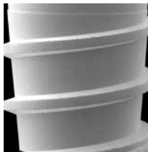
プラマRFインプラントのスレッドは、ピッチ1.50 mm、深さ0.40 mmのトライアングル形状です。
