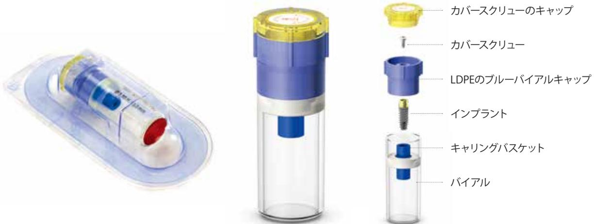
3 口腔内に挿入する直前にバイアルのブルーキャップを外します。カバースクリューの入った透明キャップを外さないように注意してください。バイアル内部のキャリングバスケットとカバースクリューにはカラーコードを採用しているため、インプラント径を容易に確認することができます。
