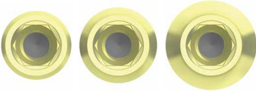
プラマインプラントのコネクションは、プレミアムシステムで既に採用されているコレックスコネクションです。20年の臨床実績に裏付けられたコレックスコネクションは、コネクション内部のサポートカラーが補綴物の高い安定性を保証します。また、連結部の変形を防止し安全なグリップを可能にする特殊なイージーインサートドライバーを使用することでマウントレステクニックにより安全な埋入ができます。内部へキサゴンによるコネクションは、補綴物の高い安定性の確保と、咬合荷重による補綴構造体を受ける抵抗性を高めます。プラマインプラントは、5,000,000サイクルの力学的疲労抵抗試験により、その安全性が確認されています。
