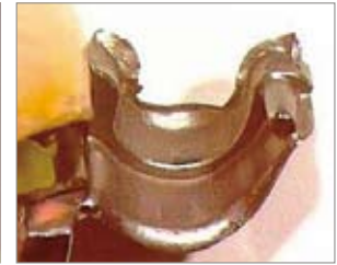
ブレーシングアームの内面
