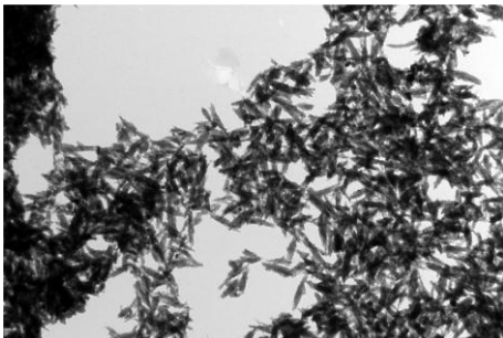
図2 凝集した生体模倣性CHAナノ結晶のTEM画像 短縮形: CHA, 炭酸塩ハイドロキシアパタイト; TEM, 透過電子顕微鏡法
